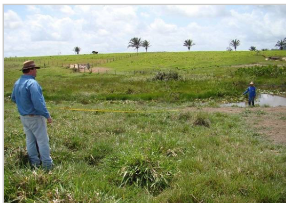
Figura 4 - Demarcação de Área de Preservação Permanente (margem de reservatório artificial) com uso de trena.
