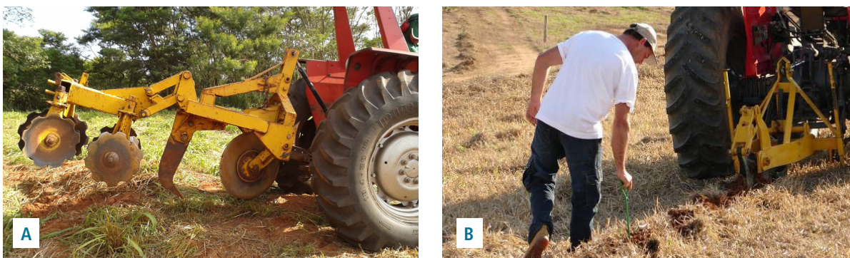
Figura 17 – Exemplos de área com o mato já seco, após aplicação de herbicida, (A) sendo preparada para o plantio com um subsolador florestal e (B) técnico medindo a profundidade de subsolagem com uma haste de ferro.
