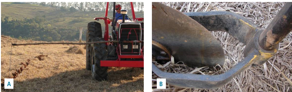
Figura 18 – Uso de um cabo de madeira com uma corrente em sua extremidade para a orientação da subsolagem em relação à linha adjacente (A) e disco de corte do subsolador cortando a palhada já seca (B).
