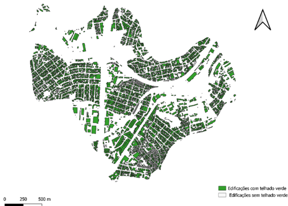
Figura 3 – Edificações com telhado verde – simulação
